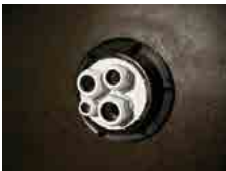
4. HL801 Rohrdurchführung mit fixierten Durchgangverschraubungen in die vorbereitete Rohrabdichtung (HL800) einsetzen, Sicherheitsmutter der Rohrabdichtung HL800 festziehen
