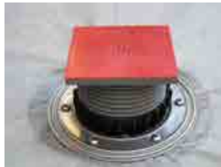
5. Filtervlies zwischen Edelstahlklemmelement (HL83.0) und dem Aufstockelement (HL85N) klemmen, Entwässerungsring (HL180) aufsetzen, Aufsatzrahmen mit Bauschutz an das fertige Plattenniveau anpassen
